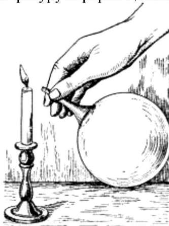
Рис. 68. Воздух вытесняется стенками мыльного пузыря.
