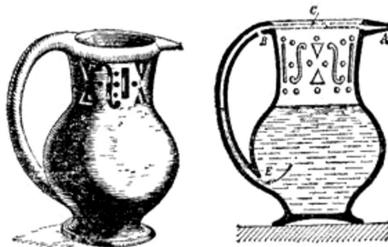
Рисунок 63. Обманчивый кувшин конца XVIII века и секрет его устройства.
