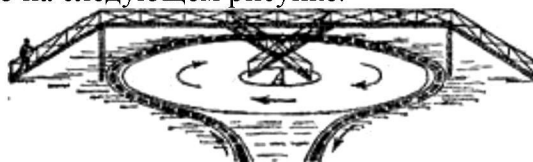
Рисунок 5. Станция безостановочной железной дороги.
