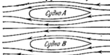
Рисунок 73. Два судна, движущиеся параллельно, как бы притягивают друг друга.
