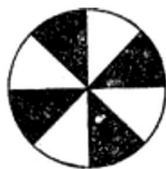
Рисунок 144. Диск для определения скорости вращения двигателя.
